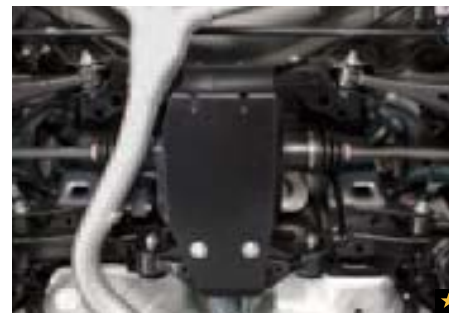
44 Differenzialschutz hinten E515EAJ300 Zum Schutz des Differenzials vor Beschädigungen von unten. Einbausatz zur Montage zusätzlich notwendig.
