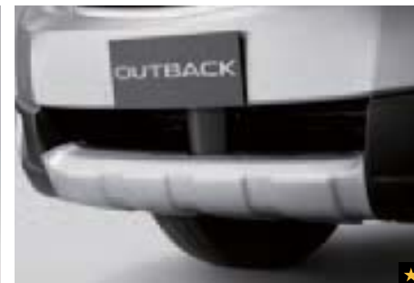
22 Kunststofffrontblende Aluminiumoptik E555EAJ000 Zum Schutz des Fahrzeugs vor Steinschlag. Verstärkt die Offroad-Optik.
