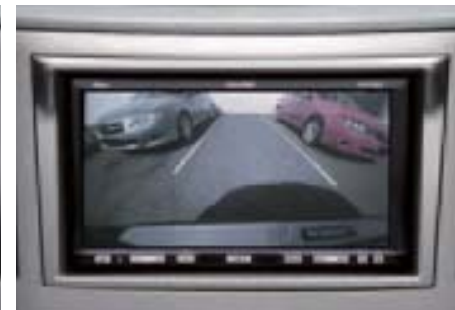
110 CCD Rückfahrkamera mit 270.000 Pixel SEFTAJ6100 Uneingeschränkte Hecksicht auf dem Navigationsdisplay nach Einlegen des Rückwärtsganges. *Nur in Verbindung mit Navigationssystem SEFTAJ6004.
