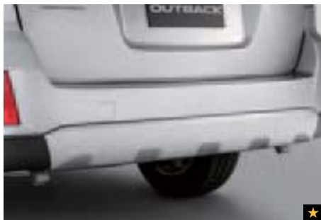
24 Kunststoffheckblende Aluminiumoptik E555EAJ100 Zum Schutz des Fahrzeugs vor Steinschlag. Verstärkt die Offroad-Optik.
