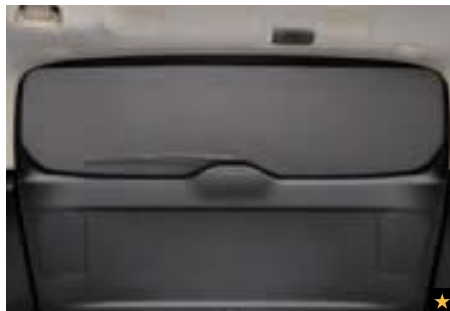
93 Sonnenschutzelement (Heckscheibe Laderaum) F505EAJ000 Zum Schutz vor Sonneneinstrahlung und zum Abdunkeln des Laderaums.
