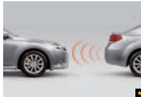
117 Ultraschall Einparkhilfe für hinten SEWAYA2003 Sicheres und einfaches Einparken mit 4 Sensoren. Akustische und optische Warnung.
