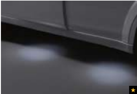
106 Bodenlampen für Schweller H471SAJ000 Zur Beleuchtung der Seite und eines Bereichs unter dem Fahrzeug. Das Licht wird beim Entriegeln der Türen aktiviert. *Kabelbaum erforderlich.
