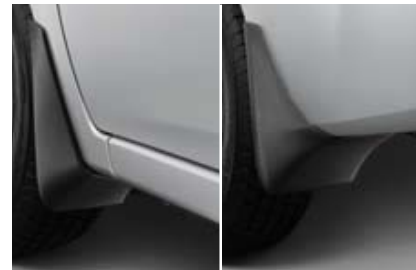
17 Schmutzfängersatz (vorne, hinten) SEBUF22000, SEBUF22100 ★ E Gegen Verschmutzung der Fahrzeugunterseite.
